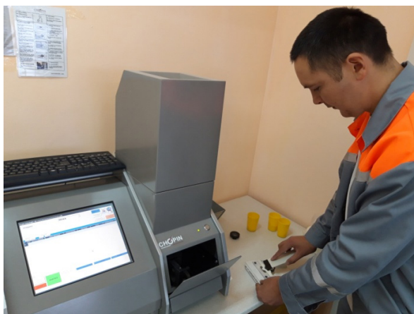
Рис. 2. Процесс проведения анализа образца муки на приборе ИНФРАНЕО
