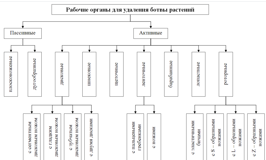
Рис. 1. Классификация рабочих органов ботвоудаляющих машин для удаления ботвы овощных культур и корнеклубнеплодов
