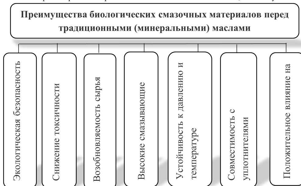
Рис.1. Преимущества биологических смазочных материалов перед традиционными (минеральными) маслами
