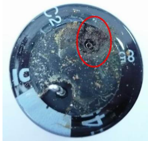
Рис. 2. Сгорание контактов в результате превышения напряжения или механических повреждений
