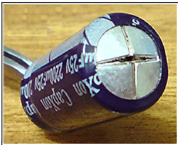
Рис. 1. Вздутие конденсатора в результате превышения номинала напряжения
