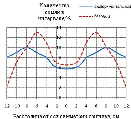
Рис. 2. График распределения семян по ширине засеваемой полосы
