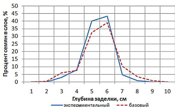
Рис. 3. Определение глубины заделки семян: а) замеры; б) равномерность распределения семян по глубине
