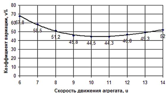
Рис. 5. График зависимости неравномерности распределения семян (v) зерновых культур по площади посева от скорости движения агрегата (u)
