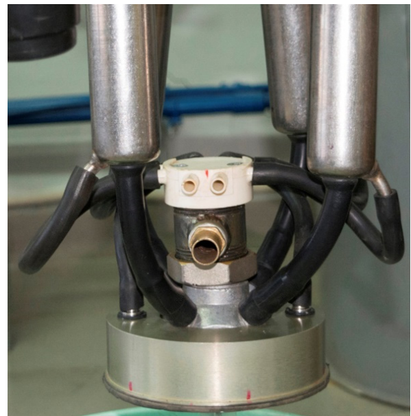
Рис. 1. Подвесная часть доильного аппарата: а – схема; б – общий вид 1, 2 – стаканы; 3 – коллектор; 4, 7, 8, 10, 11 – камеры; 5 – полый корпус; 6 – поршень; 9 – демпфер; 12, 13 – каналы; 14, 15, 20 – патрубки; 16 – клапан; 17 – выходной молочный патрубок; 18 – отсасывающая трубка; 19 – отверстие для впуска воздуха.
