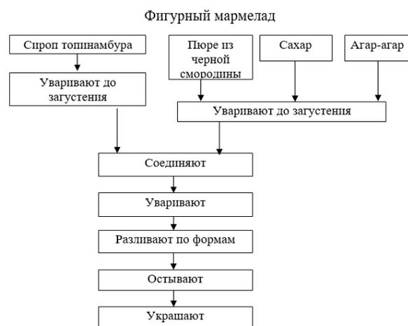
Рис. 1. Процесс изготовления фигурного мармелада
