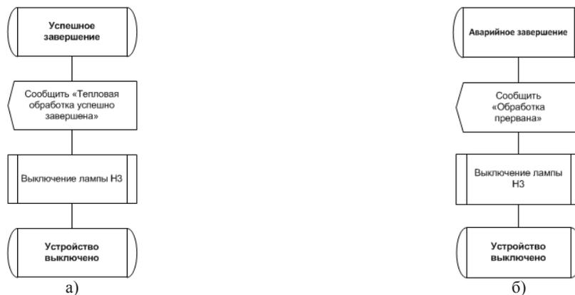
Рис. 5. Алгоритмы перехода в состояние «Устройство выключено» из двух конечные состояния «Успешное завершение» (а) и «Аварийное завершение» (б)
