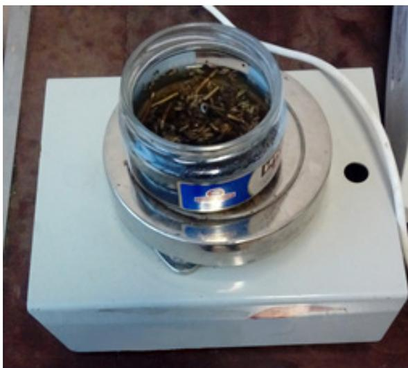
Рис. 5. Экстракционная установка с магнитной мешалкой
