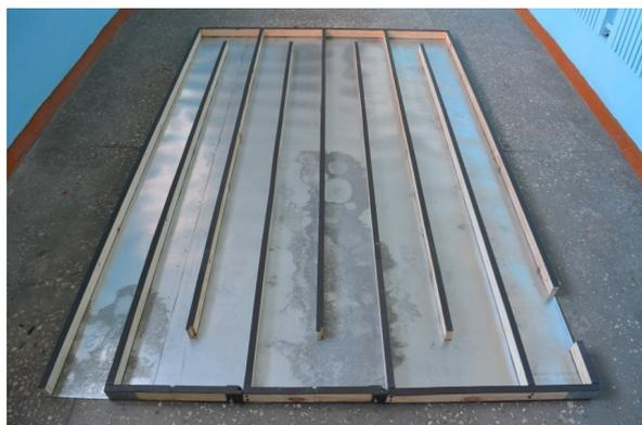
Рис. 3. Вид средней камеры комбинированного теплообменника
