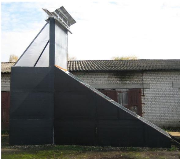
Рис. 1. Опытный образец барабанной гелиосушилки
