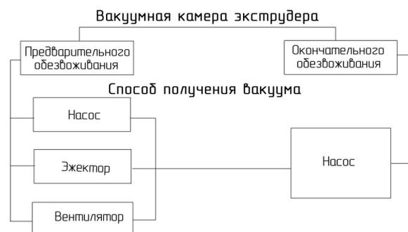
Рис. 1. Классификация вакуумных камер экструдеров
