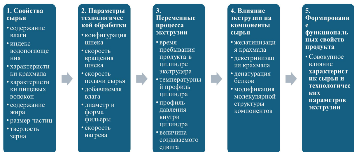
Рис. 1. Взаимосвязь свойств сырья, параметров экструзии и функциональных характеристик экструдированных снековых продуктов
