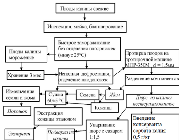
Рис. 2. Технологическая схема комплексной переработки плодов калины [12]
