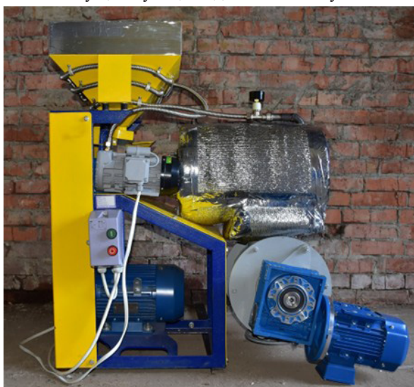
Рис. 1. Модернизированный одношнековый экструдер ЭК-40 с вакуумной камерой
