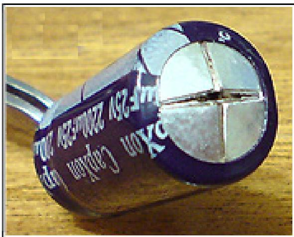
Рис. 1. Вздутие конденсатора в результате превышения номинала напряжения
