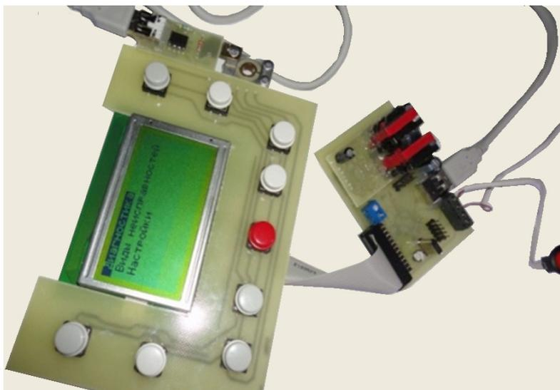
Рис. 4. Бортовая система диагностирования
